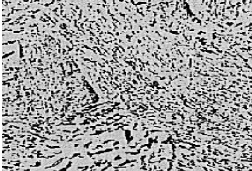
Figure (I-7): structure bainitique dans un acier de 0.22 % de carbone. [4]
